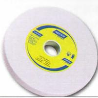
アルミナ単結晶砥粒とWA砥粒の性質を併せ持ち、切れ味と破砕性が良いので、一般研削から工具鋼等の高硬度材料の精密研削に至るまで幅広い用途に適しています。
